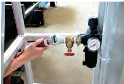
FRL integral (Filtro, regulador y lubricador) La unidad de preparación de aire se vende por separado.
