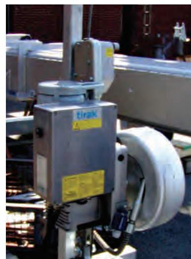
Cabestrante Tirak® con carrete pasivo en una plataforma
